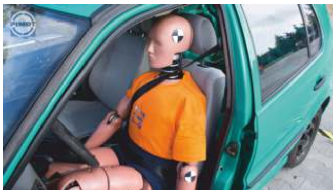
Během nárazu vozidla se sloupem nebyla bezpečnostní zóna řidiče v kabině narušena.
